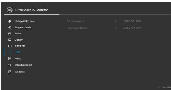
**HINWEIS:** Da der Anschluss USB-C den DisplayPort Alternate Mode unterstützt, muss USB-Auswahl für USB-C nicht eingerichtet werden.
