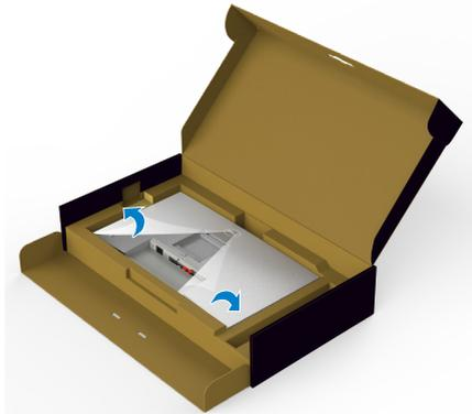
6. Schieben Sie die Riegel am Ständer in die Steckplätze an der rückseitigen Abdeckung des Displays und drücken Sie die Ständerbaugruppe nach unten, damit sie einrastet.
