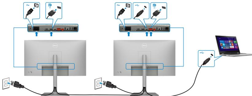
**HINWEIS:** Die maximale Anzahl unterstützter U2722DE über MST unterliegt der Bandbreite der USB-C-Quelle. Bitte beachten Sie „[Produktspezifische Probleme - Kein Bild bei Verwendung von USB-C MST](#)“.
