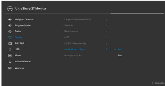
Wenn Monitor 2 Multi-Monitor Sync unterstützt, wird die MMS-Option zur Synchronisierung ebenfalls auf **On (Ein)** gesetzt.
