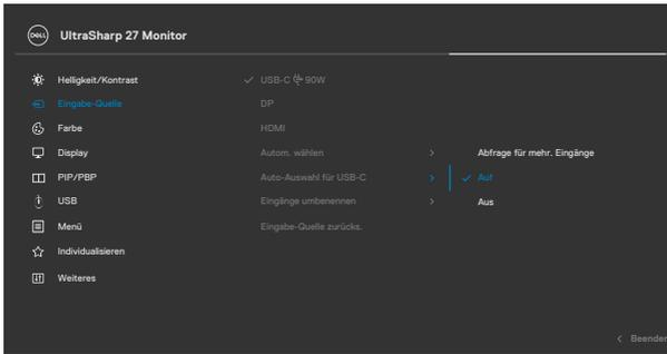
3. Stellen Sie sicher, dass die USB-Anschlüsse und die Videoeingänge entsprechend gepaart sind.
