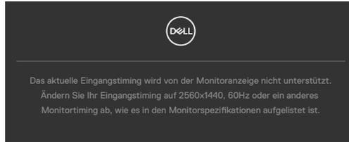
Das bedeutet, dass der Monitor sich nicht mit dem vom Computer empfangenen Signal synchronisieren kann. Die durch diesen Monitor adressierbaren horizontalen und vertikalen Frequenzbereiche können Sie den **Technische Daten des Monitors** entnehmen. Der empfohlene Modus beträgt **2560 x 1440**.
