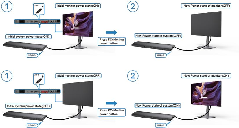
Wenn Monitor und PC eingeschaltet sind, fragt Sie der Bildschirm bei 4-sekündigem Gedrückthalten der Ein-/Austaste am Monitor, ob Sie den PC herunterfahren möchten.
