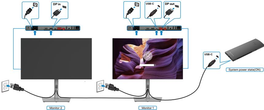
Ebenso ist ein PC in einem anfänglich eingeschalteten Zustand mit zwei Monitoren verbunden, und der Betriebsstatus des PC-Systems wird mit der Ein-/Austaste von Monitor 1 synchronisiert. Wenn Sie die Ein-/Austaste von Monitor 1 oder PC drücken, werden sowohl Monitor 1 als auch PC ausgeschaltet. Gleichzeitig bleibt Monitor 2 im Bereitschaftsmodus. Sie müssen die Ein-/Austaste an Monitor 2 zum Ausschalten manuell drücken.
