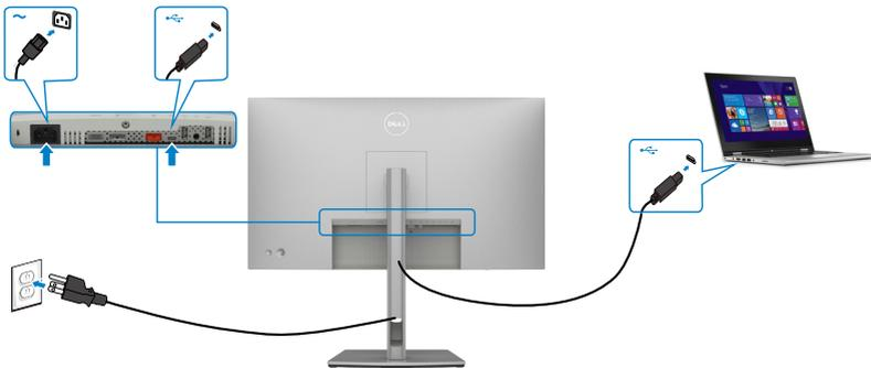
**HINWEIS:** Diese Verbindung dient nur dem Upstream, nicht der Videoübertragung. Zur Anzeige ist eine weitere Videoverbindung erforderlich.
