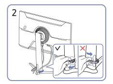
Ziehen Sie an der rechten Seite der STANDFUSSKABEL-HALTERUNG zum Entfernen von dem Standfuß. Die linke Seite des HALTERUNGSSTÄNDERKABELS kann beschädigt werden, wenn mit Gewalt daran gezogen wird.
