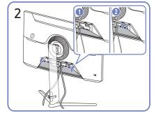
Ordnen Sie die Kabel entlang der Biegungsneigung der Kabel und ziehen Sie die Kabel aus den Vertiefungen der HINTEREN NEBENABDECKUNG.
