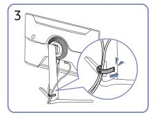
Verlegen Sie beide Kabel wie in der Abbildung gezeigt im Kabelhalter am Standfuß (STANDFUSSKABEL-HALTERUNG), um die Kabel zu organisieren.
