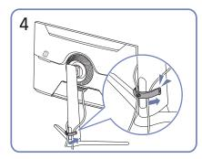
Verlegen Sie beide Kabel wie in der Abbildung gezeigt im Kabelhalter am Standfuß (STANDFUSSKABEL-HALTERUNG), um die Kabel zu organisieren.
